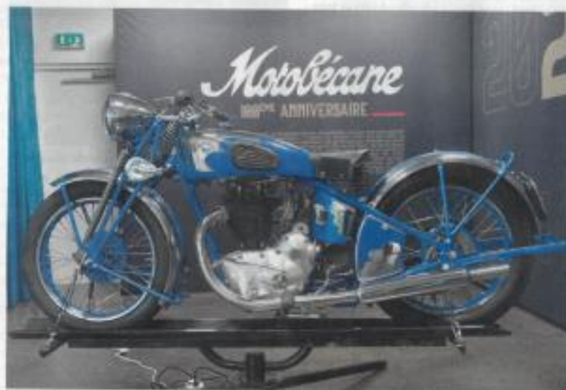
▲ Une splendide Motobécane SSC GS de 1936, moteur 500 cm 3 Bloc 5 et ligne dessinée avec l'air par Géo Ham.
