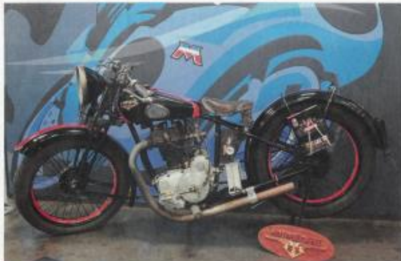
▲ La 144 C (Motocofort) est un modèle animé par un moteur de 350 cm 3 culbuté. Celle-ci a été produite en 1930.
