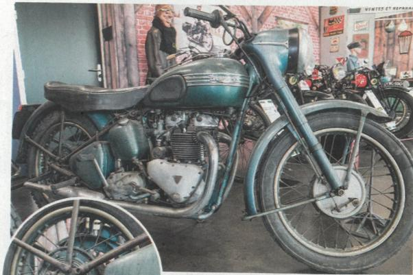
◀ Contrairement aux apparences, cette Triumph Thunderbird de 1955 possède bien une suspension arrière... Le moyeu oscille entre deux ressorts hélicoïdaux, l'axe de roue reste fixe.
